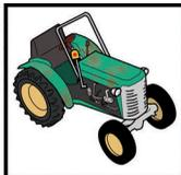
Depuis le 1er janvier 2010, les tracteurs doivent être équipés soit d'une structure anti-retournement (arceau pliable avant ou arrière), cabine ou cadre. Le renversement de tracteur est la première cause d'accident mortel avec des machines. Les trois quarts de ces accidents interviennent aux champs. Le risque de renversement peut être évité en adoptant de bonnes pratiques :
